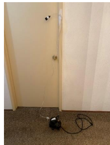
圖6：用於記錄灰塵的空氣採樣監控器盒和泵
