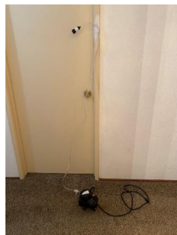
Figura 6: Monitor con casete y bomba del muestreo de aire utilizados para el registro de polvo.
