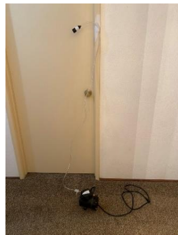
Hình 6: Hộp kiểm soát mẫu không khí và bơm được sử dụng để ghi nhận về bụi
